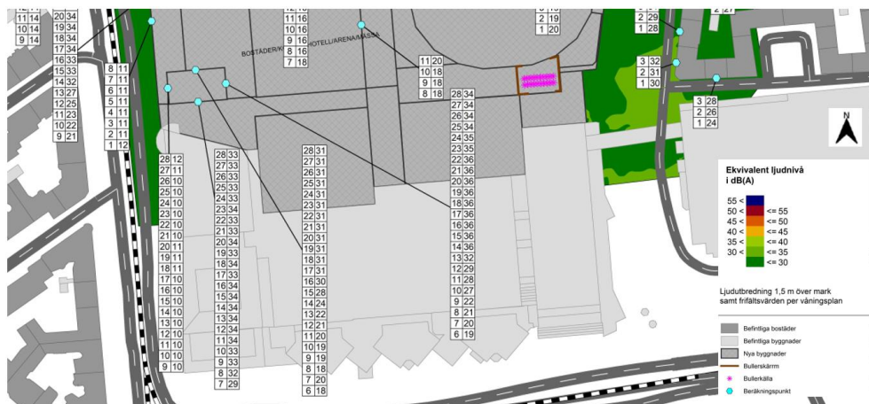
Figur 28. Buller från kylanläggning (Källa: Norconsult, 2024). Bild 2 av 2. Figur anpassad för läsbarhet av Tyréns. För figur i original format se Norconsult, 2024. Norrpil tillagd av Tyréns.
