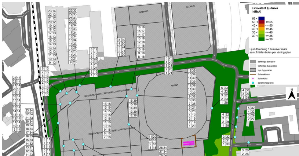
Figur 27. Buller från kylanläggning (Källa: Norconsult, 2024). Bild 1 av 2. Figur anpassad för läsbarhet av Tyréns. För figur i original format se Norconsult, 2024. Norrpil tillagd av Tyréns.
